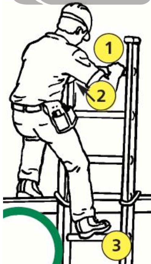
شکل ۱۵- تماس سه نقطه اتکا
