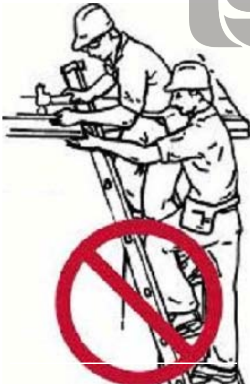
شکل ۱۲- استقرار همزمان دو نفر ممنوع
