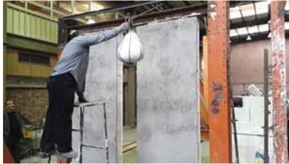
شکل (۵-۱) آزمایش ضربه جسم نرم سنگین
