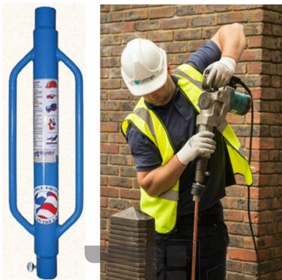
شکل (۲-۴): دو نمونه چکش مخصوص کوبیدن هیله (سمت راست چکش برقی، سمت چپ چکش دستی)
