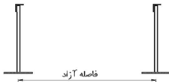
شکل ۲-۸- فاصله‌ی آزاد بین تیرچه‌های فولادی
