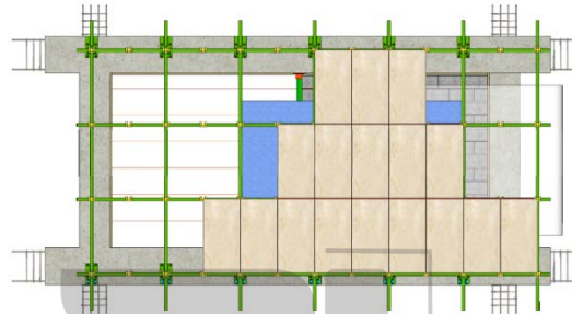
شکل ۴-۱۳- جزئیات اجرای نمای پرده‌ای سنگی
