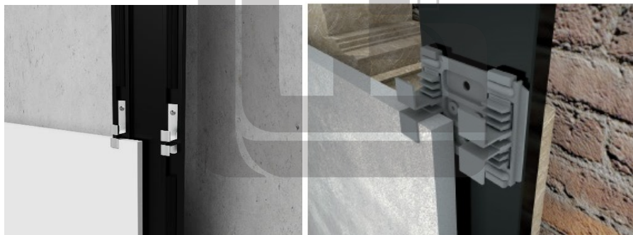
شکل ۷-۸- نمونه‌هایی از سیستم نصب نمایان
