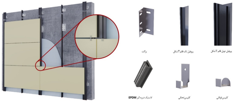
شکل ۷-۹- اجزای سیستم نصب نمایان
